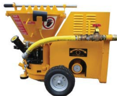
Показаният модел SOVE изисква 90cfm по-малко стъстен въздух от SOVA
