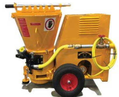
Показаният модел LOHE изисква 90cfm по-малко стъстен въздух от необходимия за LOVA
